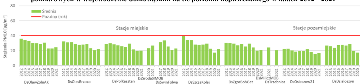
ts 1 Przebieg wartości średniej rocznej stężenia pyłu zawieszonego PM10 na poszczególnych stanowiskach pomiarowych w województwie dolnośląskim na tle poziomu dopuszczalnego w latach 2012 - 2021
